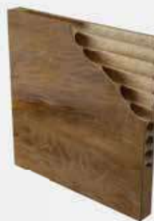
(B) Płyta wiórowo-otworowa
